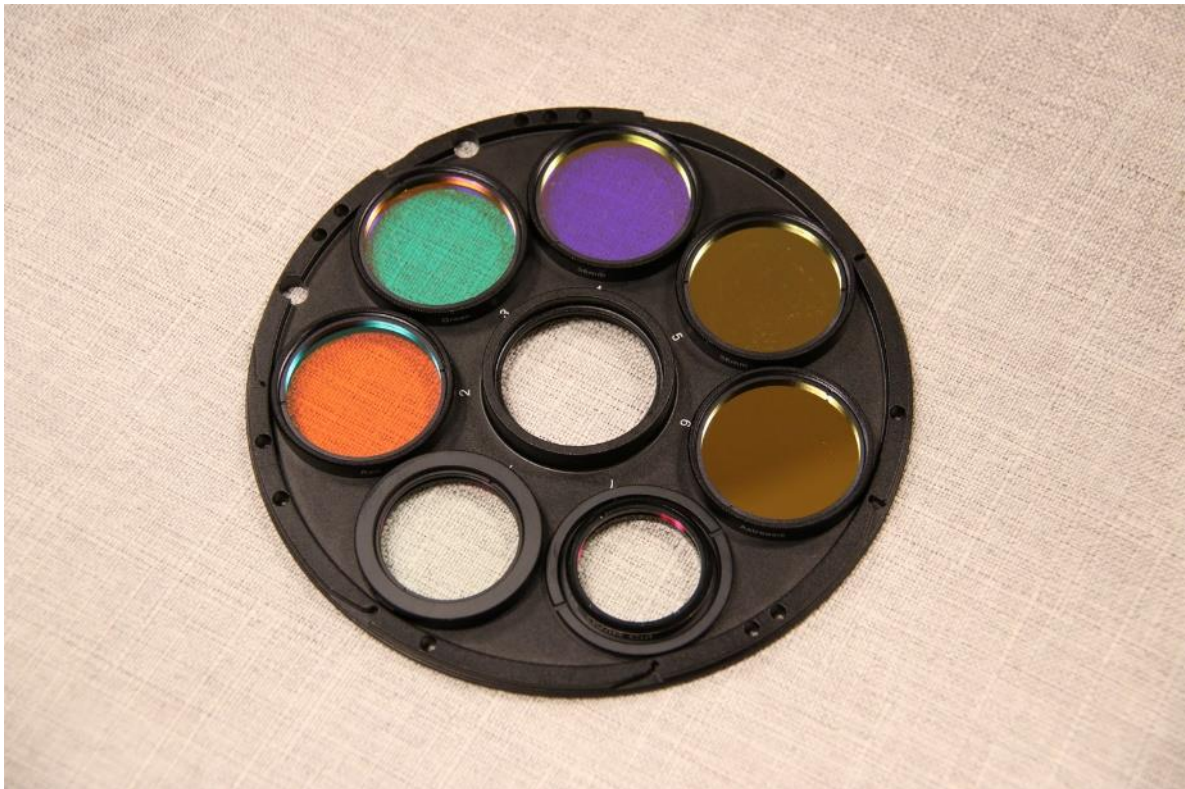
图 4-5 滤镜在滤镜盘上安装后的效果
